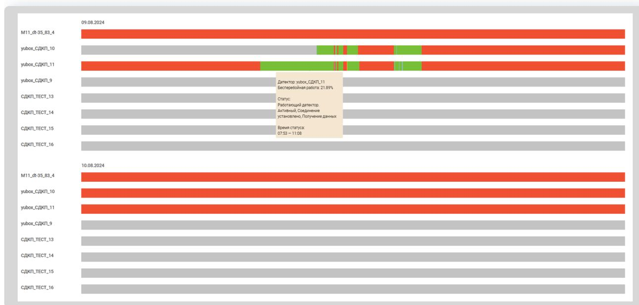
Зеленым цветом выделяются временные промежутки, в которые детектор работал без ошибок. Желтым - временные промежутки, в которые детектор работал с незначительными ошибками. Красным – промежутки, в которые детектор не работал, синим – промежутки, когда детектор находится в настройке. Светло-серым, детектор был удалён из проекта/перемещён в другой проект. При наведении на участки диаграммы пользователю отображаются статусы работы оборудования, зарегистрированные во время работы детектора.
